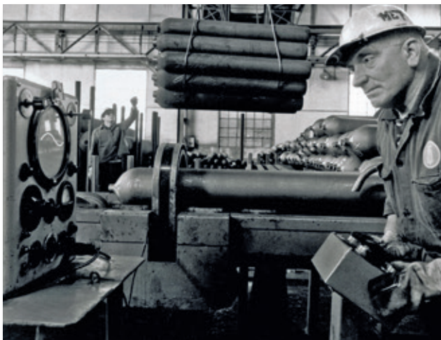
Figura 6: Due Reparti controllo bombole a confronto dopo mezzo secolo. A sinistra – Dalmine. Collaudo materiali. Controllo bombole alla fine degli anni '60. (Foto: Cremonini, © Fondazione Dalmine) A destra – TenarisDalmine. Reparto FTM. Controlli Non Distruttivi. 2019. (Foto: Photo Studio U.V., © Tenaris)
