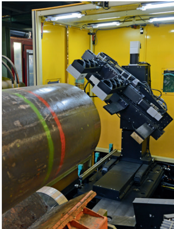
Figura 5: Due Reparti Produzione dei tubi a confronto dopo tre quarti di secolo. Il controllo visivo e quello al laser sono tecnologie distanti anni luce. A sinistra – Collaudo bicchieri (tubi) di grande diametro. Fine anni '30 (Foto: Bruno Stefani per Studio Boggeri, © Fondazione Dalmine) A destra – TenarisDalmine. LEMS (Controllo e revisione al Laser). Finitura dei tubi grandi – 2012 (Foto: Photo Studio U.V., © Tenaris)
